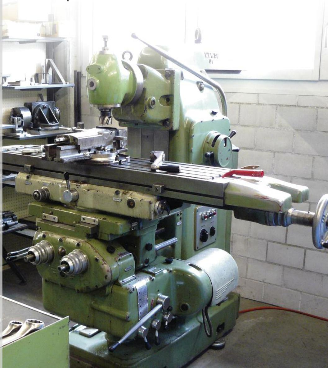
Konventionelle Fräsmaschine für die massgeschneiderte Fertigung von Einzelteilen und Kleinserien.
