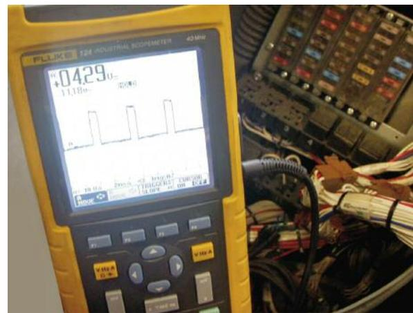
Die tr-Werkstatt ist auch für Diagnosen und Fehlersuche bestens ausgerüstet. Im Bild Spannungsprüfung mit Oszilloskop.
