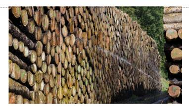
Rundholz-Nasslager: Das Porensystem des Holzes wird durch die kontinuierliche Berieselung gefüllt. So kann keine Aussenluft eindringen und das Rundholz wird konserviert.
