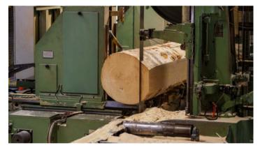
Blockbandsäge: Das Fichtenrundholz aus dem Nasslager entspricht der Qualität von Frischholz in Naturholz-Qualität – ideale Voraussetzungen für lamellierte Fensterkanteln.
