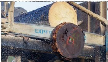
Schwertkappsäge: Hier wird auf einer Seite das Übermass der Länge abgesägt, das blanke Holz kommt zum Vorschein.
